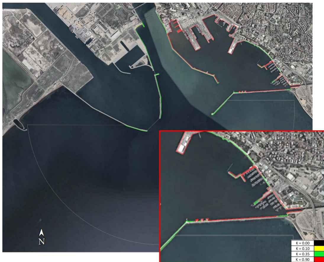
Figura 4.2 - Coefficienti di riflessione degli elementi di contorno per il modello CGWAVE – Configurazione A – Configurazione attuale.
