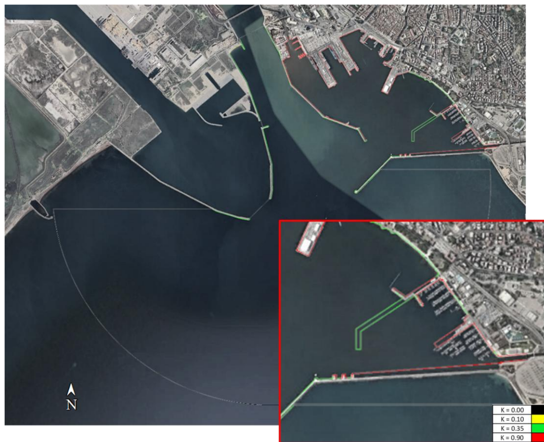
Figura 4.4 - Coefficienti di riflessione degli elementi di contorno per il modello CGWAVE – Configurazione B2 – Molo interno assorbente.
