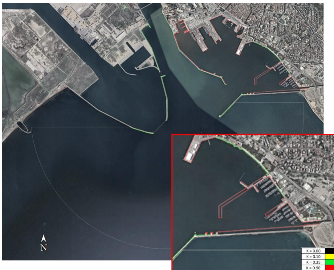
Figura 4.3 - Coefficienti di riflessione degli elementi di contorno per il modello CGWAVE – Configurazione B1 – Molo interno riflettente.
