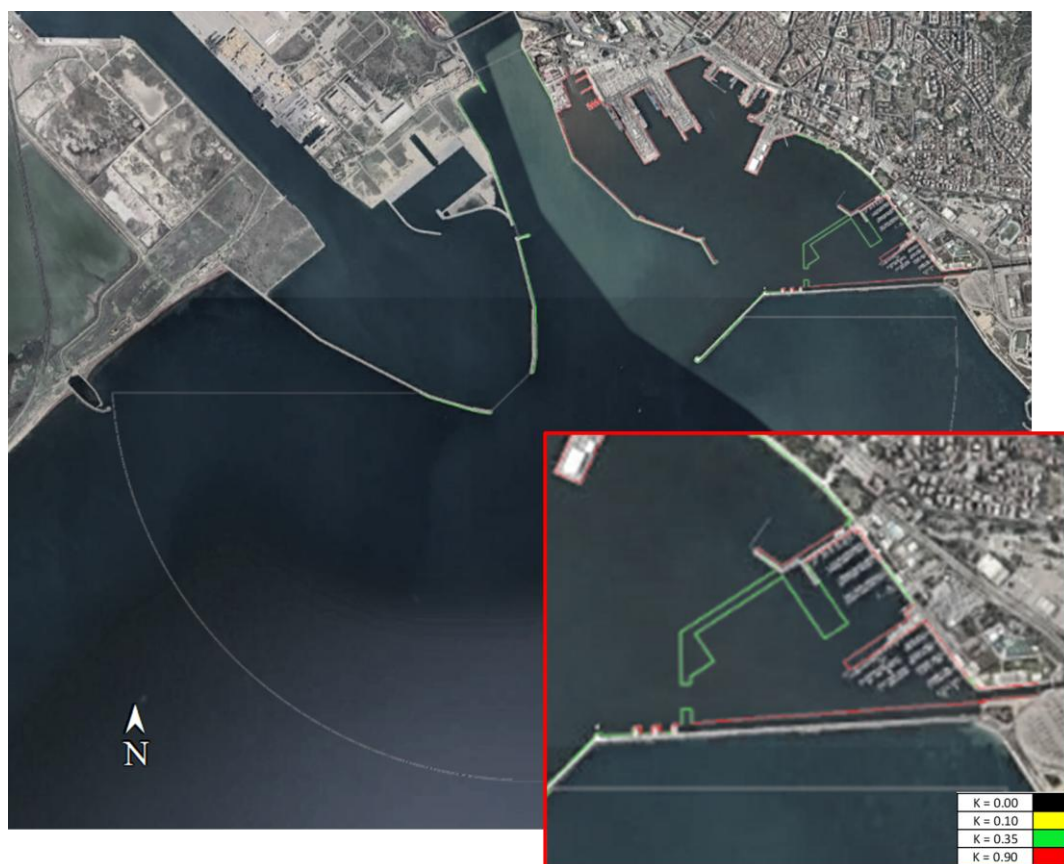
Figura 4.5 - Coefficienti di riflessione degli elementi di contorno per il modello CGWAVE – Configurazione C – ATF 2025.
